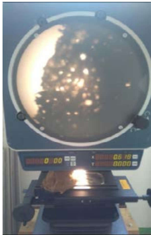
Figura 12. Muestra sometida al comparador óptico
