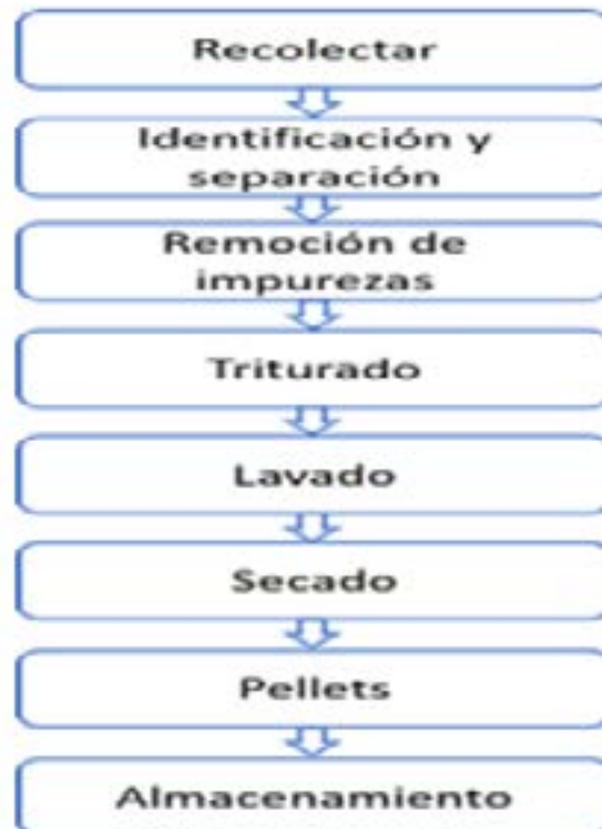
Figura 4. Proceso general para la obtención de hojuelas de plástico
