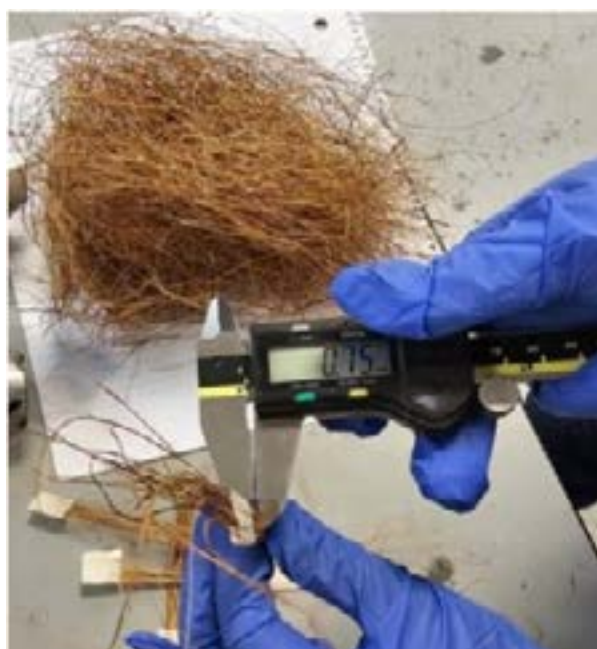
Figura 9. Medición del espesor por capa.
